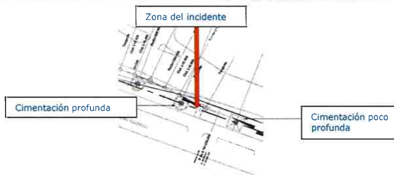
Figura IV.1.19 - Detalles de la cimentación en la zona de falla
