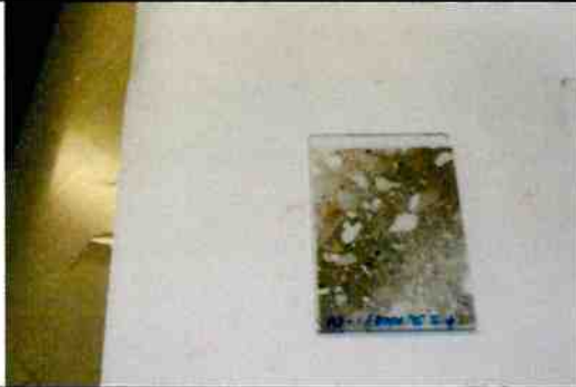
Ejemplo de muestra - Espesor ~ 30 micrones
