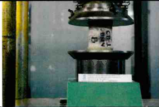
Núcleo de concreto antes de la prueba de compresión
