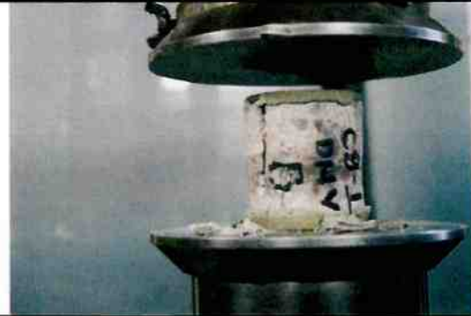
Núcleo de concreto después de la prueba de compresión
