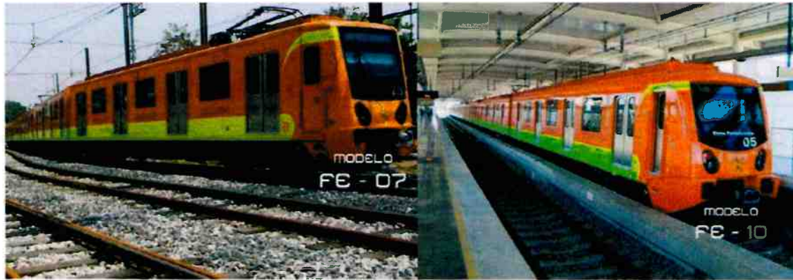
Figura I.3 Laminado a base de acerto de las series FE-07 y FE-10 fabricado por CAF. La FE-10 es operada en la L12 por STC
